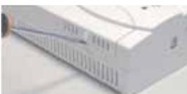
Allo scadere dei 5 anni lo strumento avvisa della necessità di sostituire il sensore tramite il lampeggio del led giallo. Facendo leva con un cacciavite sbloccare lo sportello per accedere al sensore da sostituire.
